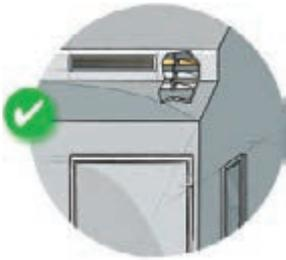
Lüftungsöffnungen in Rohrverkleidungen verhindern Dauerfeuchtigkeit.
