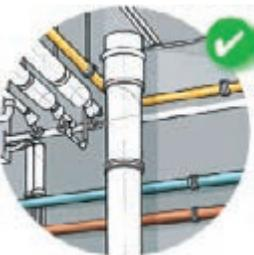
Gut befestigt und durch Farbe geschützt: so hält diese Gasleitung auch in feuchter Umgebung lange.
